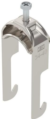
Bügelschelle mit W-Fuß, Metalldruckwanne mit gerundeten Kanten für Kabelschutz. Zur vertikalen und horizontalen Montage von 1 Einzelkabel an Winkeleisen bis < 40 mm. Mit 1-gängiger Schraube an Druckwanne, universeller Sechskant-Schraubenzkopf SW10, mit Schlitz und Kreuzschlitz. Geeignet für Montage im Innen- und Außenbereich. Der Einsatz einer Gegenwanne wird empfohlen.
