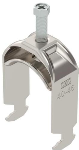
Bügelschelle mit Hammerkopf-Fuß, Metalldruckwanne mit gerundeten Kanten für Kabelschutz. Zur vertikalen und horizontalen Montage von 1 Einzelkabel an C-Profilschiene. Für Schlitzweite 16 - 17 mm. Mit 1-gängiger Schraube an Druckwanne, universeller Sechskant-Schraubenkopf SW10, mit Schlitz und Kreuzschlitz. Geeignet für Montage im Innen- und Außenbereich. Der Einsatz einer Gegenwanne wird empfohlen.
