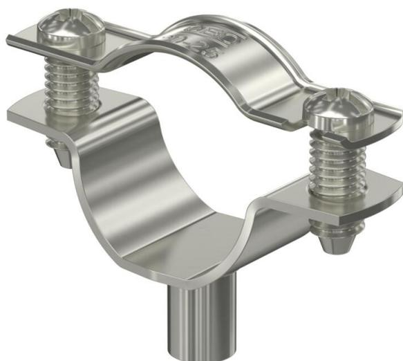
Abstandschele zur Montage von Rohren und Kabeln an Wand, Decke und Boden. Mit selbstsicherndem Oberteil. Befestigung über Ansatz mit Innengewinde. Zugelassen für den Funktionserhalt nach DIN 4102 Teil 12, Funktionserhaltklassen E 30 bis E 90.
