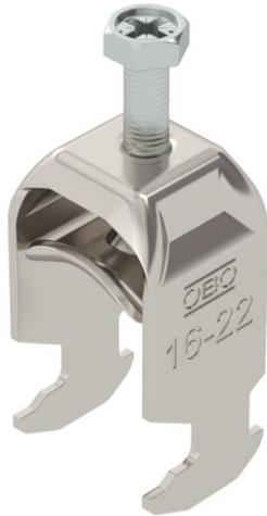
Bügelshelle mit Hammerkopf-Fuß, Metalldruckwanne mit gerundeten Kanten für Kabelschutz. Zur vertikalen und horizontalen Montage von 1 Einzelkabel an C-Profilschiene. Für Schlitzweite 16 - 17 mm. Mit 1-gängiger Schraube an Druckwanne, universeller Sechskant-Schraubenkopf SW10, mit Schlitz und Kreuzschlitz. Geeignet für Montage im Innen- und Außenbereich. Der Einsatz einer Gegenwanne wird empfohlen.
