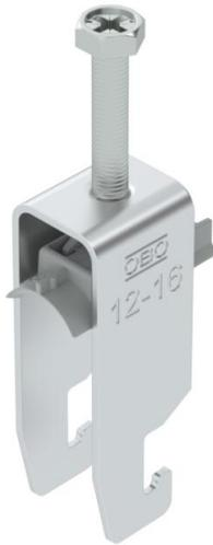
Bügelshelle mit U-Fuß, Kunststoffdruckwanne aus Polypropylen. Zur vertikalen und horizontalen Montage von 2 Einzelkabeln an C-Profilshiene. Für Schlitzweite 18 - 22 mm. Mit 1-gängiger Schraube an Druckwanne, universeller Sechskant-Schraubenkopf SW10, mit Schlitz und Kreuzschlitz. Geeignet für Montage im Innen- und Außenbereich. Mehrere Kabel sollten durch Doppelwannen getrennt werden. Der Einsatz einer Gegenwanne wird empfohlen.
