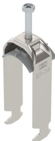
Bügelschelle mit Hammerkopf-Fuß, Kunststoffdruckwanne aus Polypropylen. Zur vertikalen und horizontalen Montage von 2 Einzelkabeln an C-Profileschiene. Für Schlitzweite 16 - 17 mm. Mit 1-gängiger Schraube an Druckwanne, universeller Sechskant-Schraubenkopf SW10, mit Schlitz und Kreuzschlitz. Geeignet für Montage im Innen- und Außenbereich. Mehrere Kabel sollten durch Doppelwannen getrennt werden. Der Einsatz einer Gegenwanne wird empfohlen.
