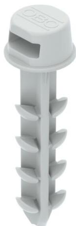
Steckdübel Delta-Push® zur Montage in der Elektroinstallation. Geeignet für Beton, Kalksandstein, Vollziegel, Hohllochziegel und Porenbeton. Werkzeuglose Montage durch Eindrücken in Bohrloch an Wand oder Decke. Ohne Schrauben. Mit Kabelbinderaufnahme bis 4,8 mm Breite und 2 mm Höhe zur Befestigung von Kabeln und Rohren.
