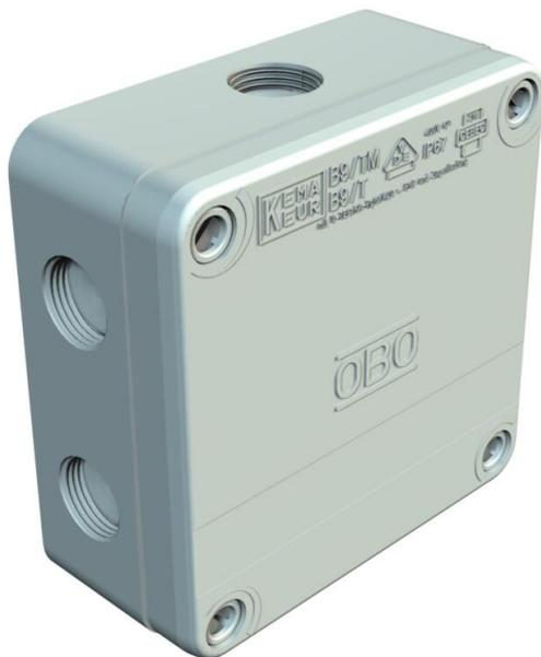
Der Kabelabzweigkasten B9/T... besteht aus zwei verschiedenen halogenfreien Kunststoffkomponenten. Er hat 8 Gewindeeinführungen mit Durchstoßmembranen (7 x M20 seitlich und 1 x PG16 im Boden) sowie eine Membraneinführung im Boden für Kabeldurchmesser bis 15 mm.
