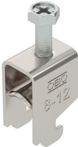
Bügelschelle mit N-Fuß, Metalldruckwanne mit gerundeten Kanten für Kabelschutz. Zur vertikalen und horizontalen Montage von 1 Einzelkabel an C-Profil-schiene. Für Schlitzweite 11 - 12 mm. Mit 1-gängiger Schraube an Druckwanne, universeller Sechskant-Schraubenkopf SW10, mit Schlitz und Kreuzschlitz. Geeignet für Montage im Innen- und Außenbereich. Der Einsatz einer Gegenwanne wird empfohlen.
