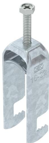
Bügelschelle mit F-Fuß, Metalldruckwanne mit gerundeten Kanten für Kabelschutz. Zur vertikalen und horizontalen Montage von 2 Einzelkabeln an Flacheisen. Mit 1-gängiger Schraube an Druckwanne, universeller Sechskant-Schraubenkopf SW10, mit Schlitz und Kreuzschlitz. Geeignet für Montage im Innen- und Außenbereich. Mehrere Kabel sollten durch Doppelwannen getrennt werden. Der Einsatz einer Gegenwanne wird empfohlen.
