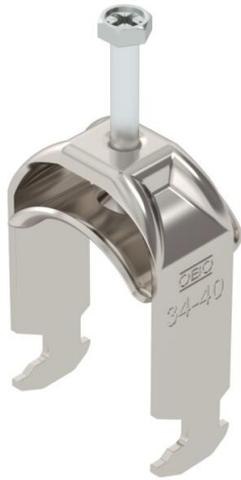
Bügelschelle mit Hammerkopf-Fuß, Metalldruckwanne mit gerundeten Kanten für Kabelschutz. Zur vertikalen und horizontalen Montage von 1 Einzelkabel an C-Profilschiene. Für Schlitzweite 16 - 17 mm. Mit 1-gängiger Schraube an Druckwanne, universeller Sechskant-Schraubenkopf SW10, mit Schlitz und Kreuzschlitz. Geeignet für Montage im Innen- und Außenbereich. Der Einsatz einer Gegenwanne wird empfohlen.
