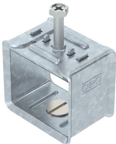
Schelle und Schraube aus Stahl tauchfeuerverzinkt, Senkschraube aus Edelstahl rostfrei, Gleitmutter aus Stahl galvanisch verzinkt.
