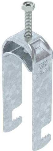
Bügelschelle mit F-Fuß, Metalldruckwanne mit gerundeten Kanten für Kabelschutz. Zur vertikalen und horizontalen Montage von 2 Einzelkabeln an Flacheisen. Mit 1-gängiger Schraube an Druckwanne, universeller Sechskant-Schraubkopf SW10, mit Schlitz und Kreuzschlitz. Geeignet für Montage im Innen- und Außenbereich. Mehrere Kabel sollten durch Doppelwannen getrennt werden. Der Einsatz einer Gegenwanne wird empfohlen.
