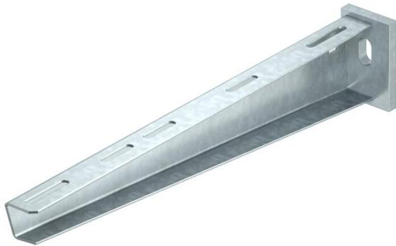
Mittelschwerer Wand- und Stielausleger mit angeschweißter Kopfplatte. Befestigung des Auslegers am U-Stiel ab der Breite 400 mm mit Sechskantschraube durch beide Holme des Stiels. Bitte dazu die passenden Distanzstücke einsetzen!
