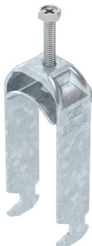
Bügelshelle mit Hammerkopf-Fuß, Metalldruckwanne mit gerundeten Kanten für Kabelschutz. Zur vertikalen und horizontalen Montage von 2 Einzelkabeln an C-Profilshiene. Für Schlitzweite 16 - 17 mm. Mit 1-gängiger Schraube an Druckwanne, universeller Sechskant-Schraubekopf SW10, mit Schlitz und Kreuzschlitz. Geeignet für Montage im Innen- und Außenbereich. Mehrere Kabel sollten durch Doppelwannen getrennt werden. Der Einsatz einer Gegenwanne wird empfohlen.
