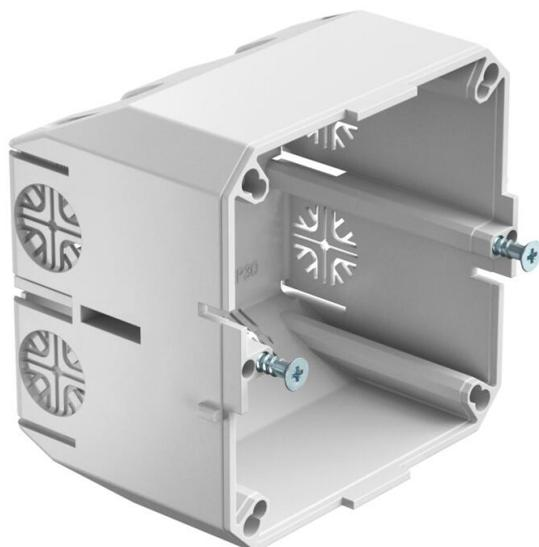
Geräteeinbaudose für den Einbau von Geräten in Tragring und Tragbügelbauweise in WDK Leitungsführungskanäle der Kanalhöhe 60 mm. Die Gerätedose wird auf die Bodenpilze aufgesteckt und mit einer Schraube in der Mitte befestigt.
