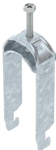
Bügelshelle mit U-Fuß, Metalldruckwanne mit gerundeten Kanten für Kabelschutz. Zur vertikalen und horizontalen Montage von 2 Einzelkabeln an C-Profilshiene. Für Schlitzweite 18 - 22 mm. Mit 1-gängiger Schraube an Druckwanne, universeller Sechskant-Schraubenkopf SW10, mit Schlitz und Kreuzschlitz. Geeignet für Montage im Innen- und Außenbereich. Mehrere Kabel sollten durch Doppelwannen getrennt werden. Der Einsatz einer Gegenwanne wird empfohlen.
