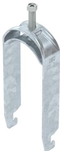
Bügelshelle mit U-Fuß, Metalldruckwanne mit gerundeten Kanten für Kabelschutz. Zur vertikalen und horizontalen Montage von 2 Einzelkabeln an C-Profilshiene. Für Schlitzweite 18 - 22 mm. Mit 1-gängiger Schraube an Druckwanne, universeller Sechskant-Schraubenkopf SW10, mit Schlitz und Kreuzschlitz. Geeignet für Montage im Innen- und Außenbereich. Mehrere Kabel sollten durch Doppelwannen getrennt werden. Der Einsatz einer Gegenwanne wird empfohlen.
