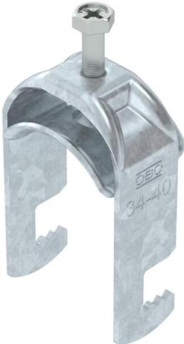
Bügelschelle mit F-Fuß, Metalldruckwanne mit gerundeten Kanten für Kabelschutz. Zur vertikalen und horizontalen Montage von 1 Einzelkabel an Flacheisen. Mit 1-gängiger Schraube an Druckwanne, universeller Sechskant-Schraubkopf SW10, mit Schlitz und Kreuzschlitz. Geeignet für Montage im Innen- und Außenbereich. Der Einsatz einer Gegenwanne wird empfohlen.
