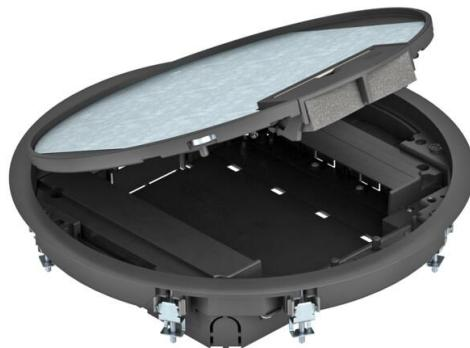
Geräteeinsatz GESR9 mit einer festen Bauhöhe von 55 mm im Innenbereich. Mit zwei Einbaugehäusen zur vertikalen Montage von Modul 45-Geräten und vier Zugentlastungen. Zur Montage der Modul 45-Geräte werden zwei Einbaurahmen benötigt.
