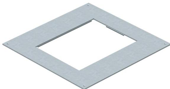
Montagedeckel für Unterflur-Zug- und -Abzweigdosen vom Typ UZD350-3/4 zum Einbau einer Einbaueinheit der Nenngröße 6. Einbauöffnung 3 mm vertieft zum nachträglichen Blindverschluss mit Deckelblindplatte.
