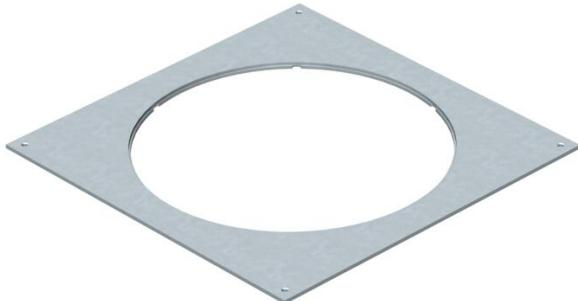
Montagedeckel für Unterflur-Zug- und -Abzweigdosen vom Typ UZD350-3/4 zum Einbau einer Einbaueinheit der Nenngröße R9. Einbauöffnung 3 mm vertieft zum nachträglichen Blindverschluss mit Deckelblindplatte.
