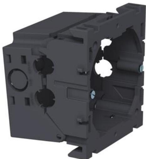
Frontrastende Geräteeinbaudose für Schalter-Systeme, mit abklappbarem und bei Bedarf auch entfernbarem Unterteil zum zeitsparenden Leitungsanschluss, mit Zuführungsöffnungen für Leitungsdurchmesser bis 14 mm. Halogenfreie Ausführung.
