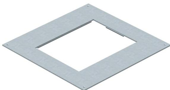
Montagedeckel für Unterflur-Zug- und -Abzweigdosen vom Typ UZD250-3/4 zum Einbau einer Einbaueinheit der Nenngröße 6. Einbauöffnung 3 mm vertieft zum nachträglichen Blindverschluss mit Deckelblindplatte.
