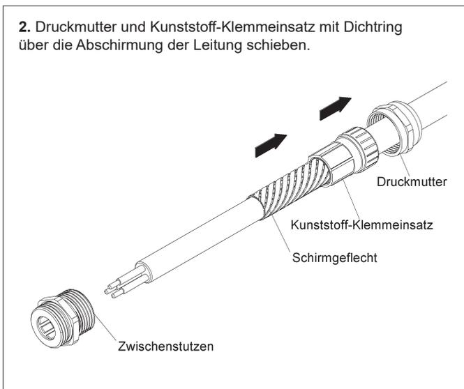
3. Das gestauchte Schirmgeflecht wird durch den Kunststoff-Klemmeinsatz auf den Metallbund am Zwischenstutzen gepreßt und so die elektrische Kontaktierung hergestellt. Das Schirmgeflecht liegt großflächig am Zwischenstutzen auf und wird durch den elektrisch leitenden Messingkörper mit der Masse verbunden.
