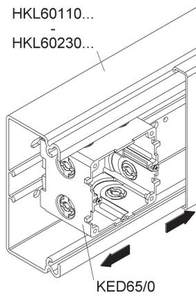
**3.** Geräteeinsatz verdrahten und mittels den Befestigungsschrauben (A) fixieren. Weiteres Anziehen senkt den Dosenrand ab und befestigt die Dose im Kanal. **Die Montage der Steckdosen darf nur durch einen autorisierten Elektrofachmann erfolgen.**
