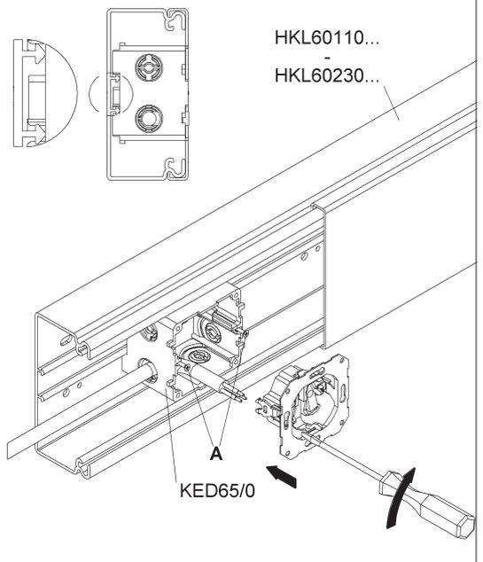
**4.** Kabelhalteklammer einsetzen, gelochter Deckelabschnitt (1-, 2- oder 3-fach) aufrasten und angrenzenden Deckel aufchieben. **Die VDE-zertifizierte Geräteeinbaudose KED65/0 kann Leitungen der Bauarten 3X1,5 mm<sup>2</sup> und 5X1,5 mm<sup>2</sup> sicher zugentlasten. Für alle anderen Leitungen von Ø 4,0 - 10,0 mm empfehlen wir die Verwendung der optionalen Zugentlastung KEDZ0410.**
