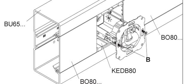
Zum nachträglichen Verschieben bei bereits eingebautem(n) Gerät(en) müssen die Befestigungsschrauben durch die Bohrungen im Tragring gelöst und nach dem Verschieben wieder festgezogen werden.
