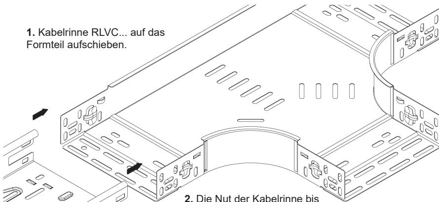
2. Die Nut der Kabelrinne bis zur Rastschlaufe führen.
