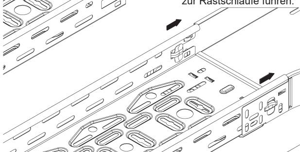
3. Durch Absenken der Kabelrinne entsteht, durch Ausformungen in den Seitenholmen und im Bodenblech, eine formschlüssige Verrastung mit dem Formteil.
