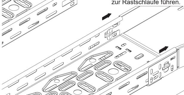
3. Durch Absenken der Kabelrinne entsteht, durch Ausformungen in den Seitenholmen und im Bodenblech, eine formschlüssige Verrastung mit dem Formteil.
