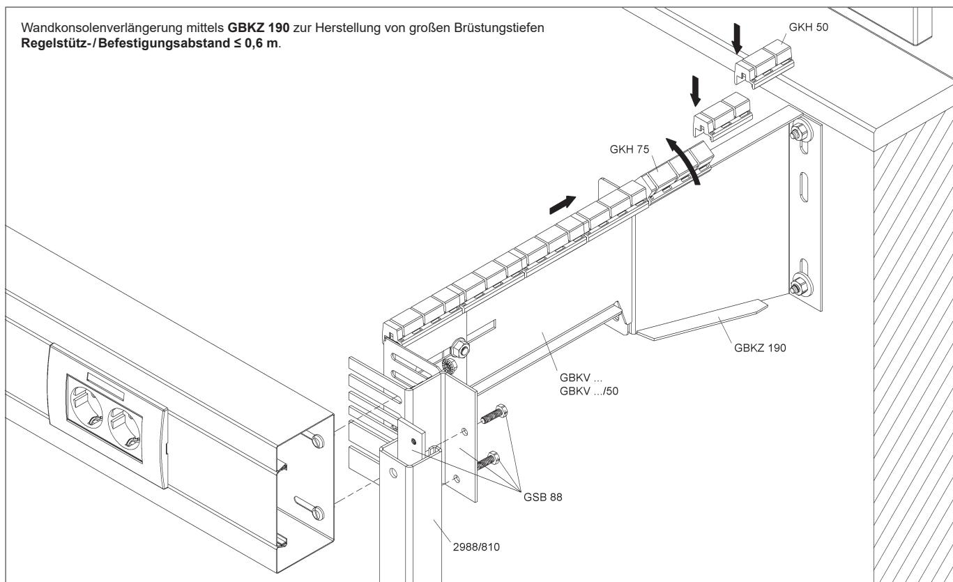
Stütze **2988/810 VC** montiert mit dem Stützen-Befestigungs-Set **GSB 88** an der Wandkonsole **GBKV...**
