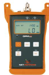
Der OPM100 wird zum Messen des optischen Leistungspegels (dBm) in Zugangs-, Telekommunikations- und CATV-Glasfasernetzen genutzt. Des weiteren kann der Pegelmesser in Verbindung mit einer optischen Laserquelle wie z.B. der OLS150MM oder OLS150SM von NetPeppers auch zum Ermitteln der Einfügedämpfung genutzt werden.
