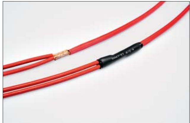
Warmschrumpfschlauch SA47 zur Anwendung bei Spleißen.
