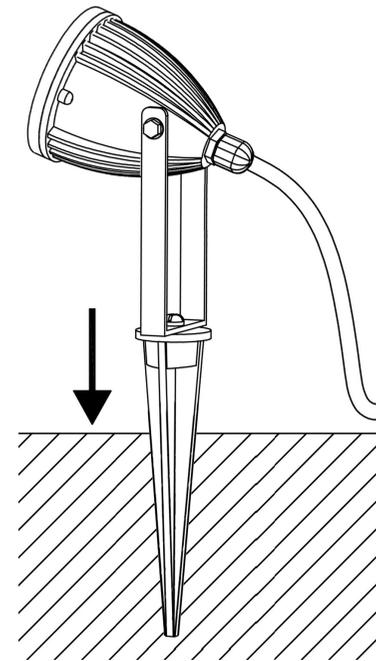
Den Strahler mit dem Erdspieß fest in den Boden stecken.
