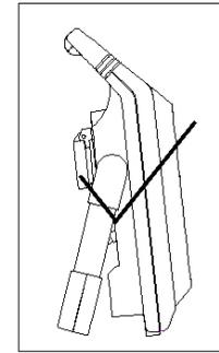
Sichern Sie den Strahler vor der Benutzung gegen Umfallen, indem Sie die Stütze vollständig ausklappen.
