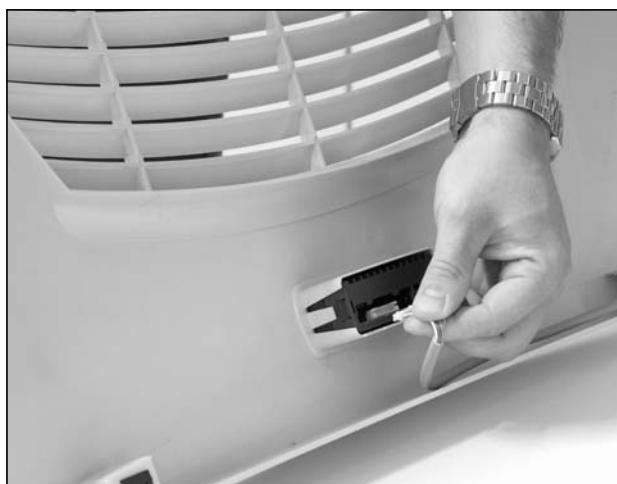
Рис. 25: Отсоединение штекера дисплея
