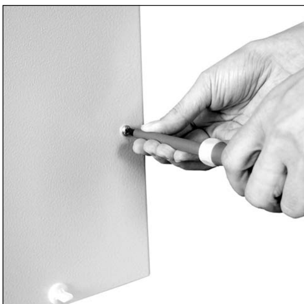
Рис. 27: Отвинчивание крепежных винтов кожуха (четыре винта)
