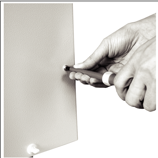
Imagen 27: Extraer los tornillos de fijación de la cubierta (extraer cuatro tornillos)
