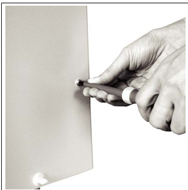
Obr. 27: Odstraňte upevňovací šrouby krytu (povolit čtyři šrouby)
