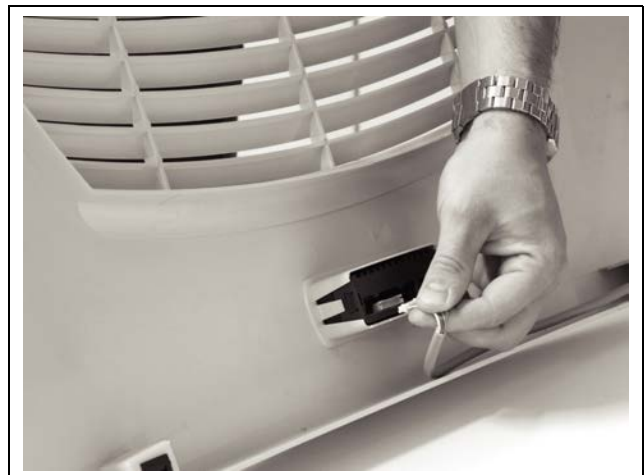
Obr. 25: Odpojte konektor od displeje
