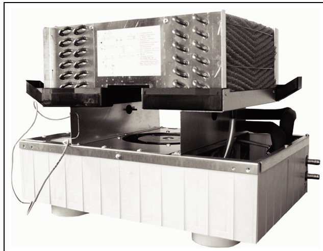
Fig. 29 : Échangeur thermique air/eau sans capot (vue de face)
