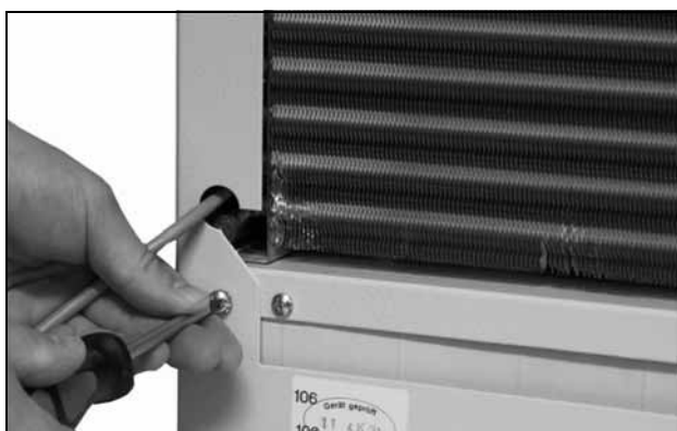
Abb. 23: Befestigungsschrauben der Haube entfernen (vier Schrauben lösen)
