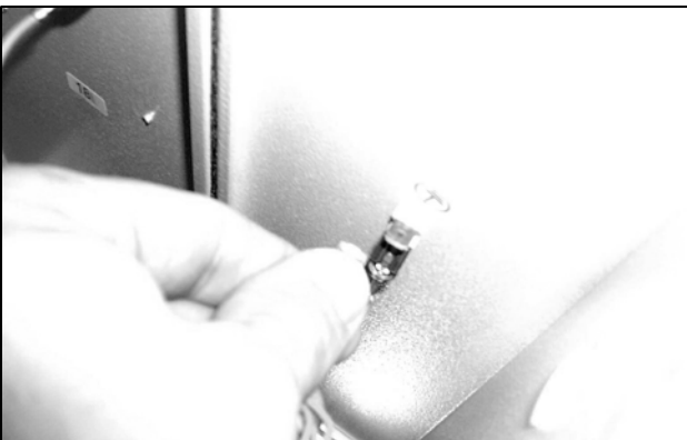
Abb. 69: Erdungskabel des Lüfters abziehen (2)
