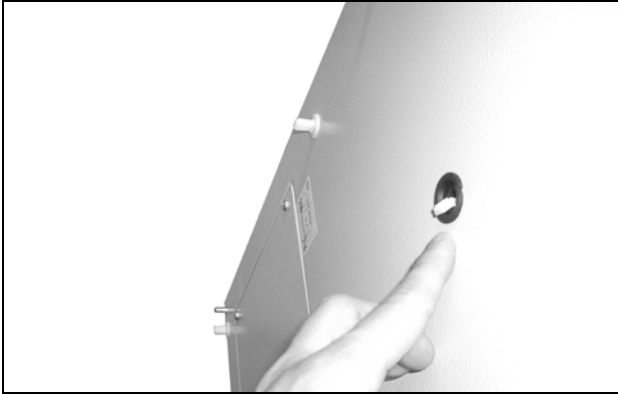
Abb. 46: Displaykabel durch Kabeldurchführung drücken
