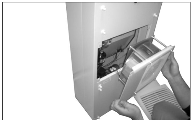
Abb. 64: Außenkreislauf Lüfter ausbauen
