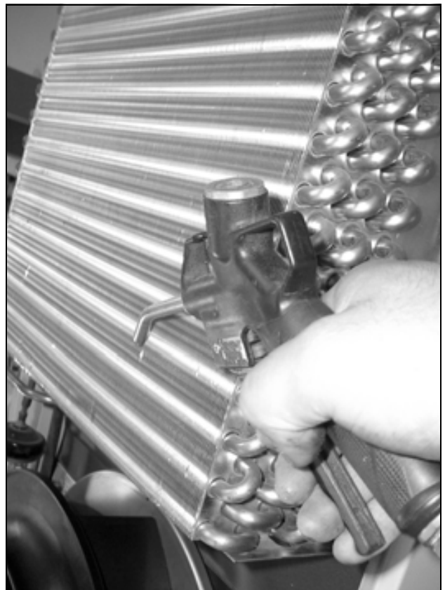
Abb. 75: Wärmetauschregister und Kompressorraum mit Druckluft ausblasen (2)
