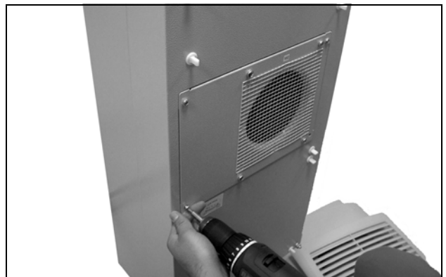
Abb. 63: Vier Schrauben des Außenkreislauf Lüfters lösen
