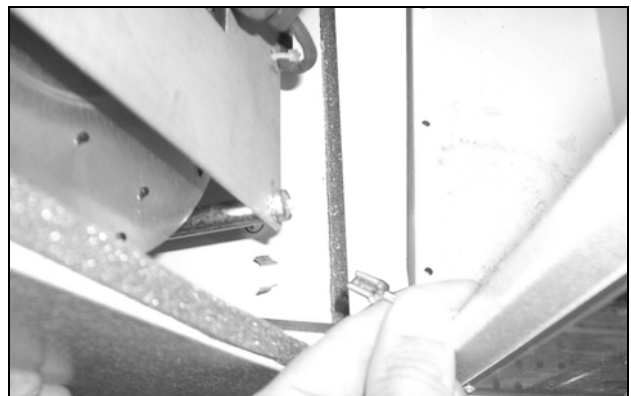
Abb. 50: Erdungskabel zwischen Haube und Chassis lösen (2)
