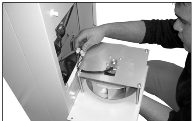
Abb. 65: Steckverbindungen des Lüfters abziehen (1)
