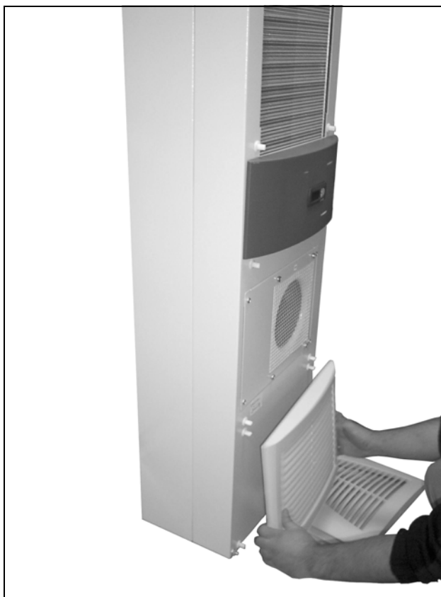
Obr. 58: Demontáž dolnej lamelovej mriežky (2)
