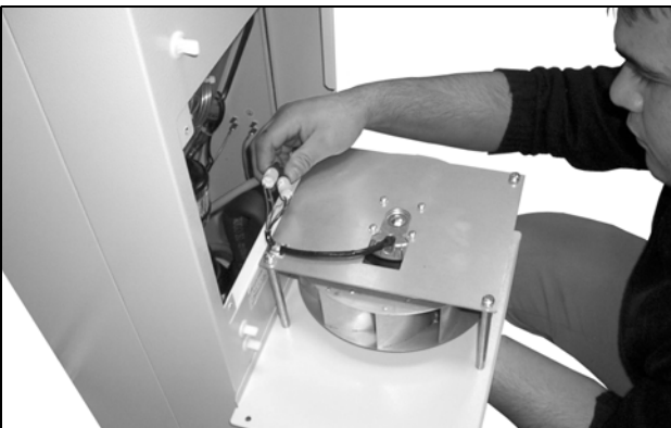
Obr. 65: Odpojenie konektorov ventilátora (1)
