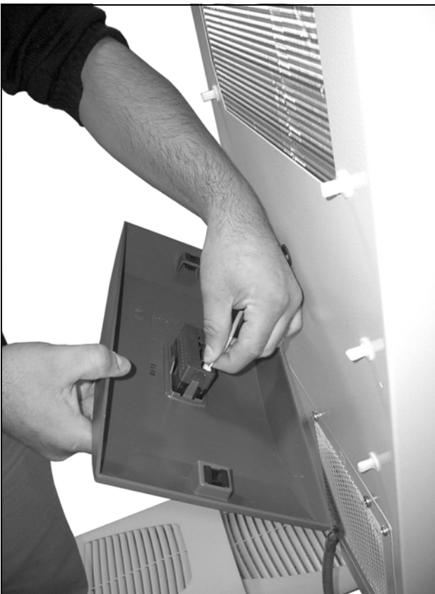
Obr. 38: Odpojenie konektora od displeja (1)
