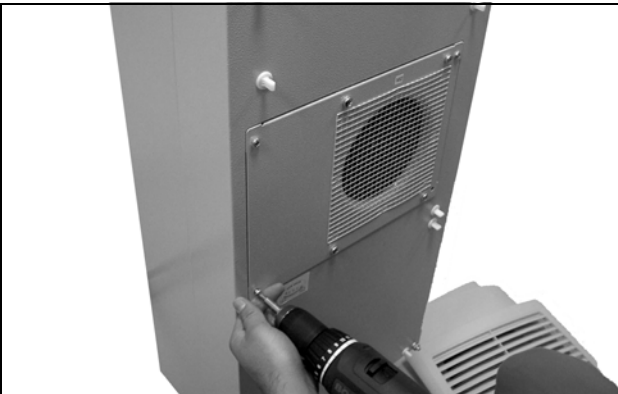
Obr. 63: Uvoľnenie štyroch skrutiek ventilátora vonkajšieho otvoru
