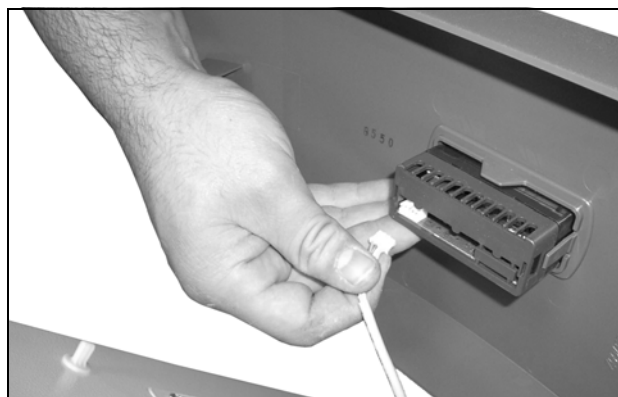
Obr. 60: Odpojenie kábla displeja
