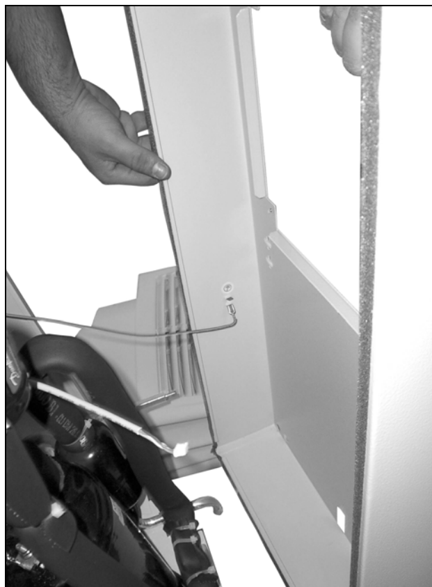
Obr. 72: Odpojenie zemniaceho kábla (1)
