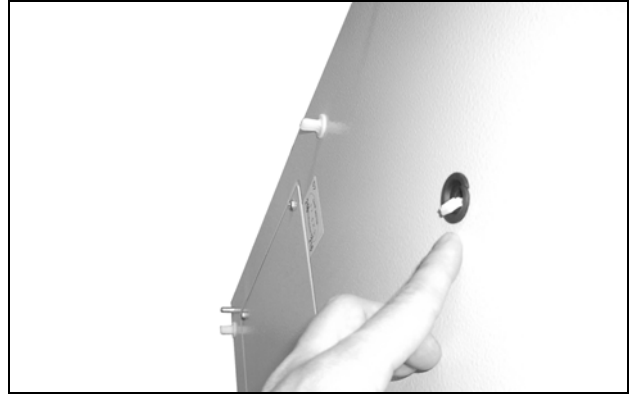
Obr. 46: Prestrčenie kábla displeja cez otvor na vedenie kábla
