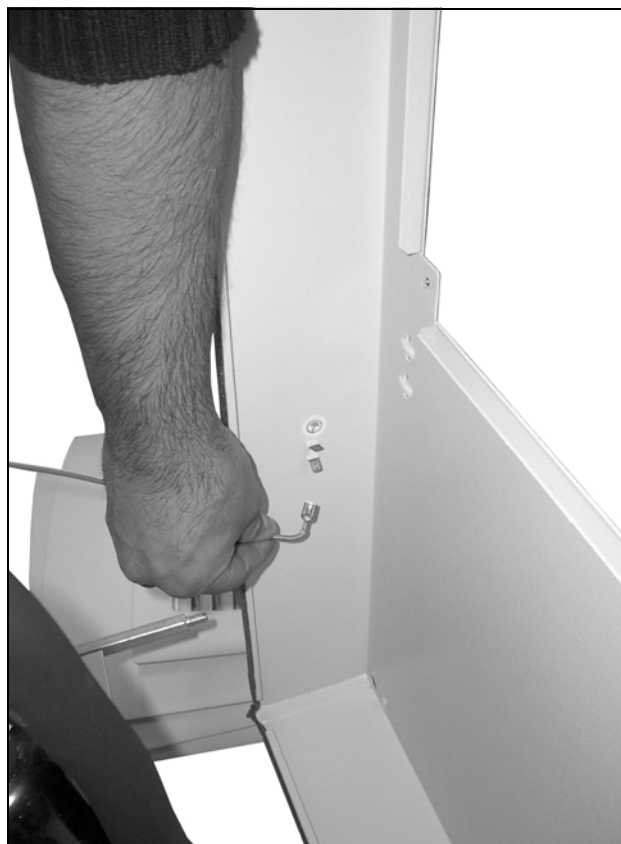
Obr. 73: Odpojenie zemniaceho kábla (2)
