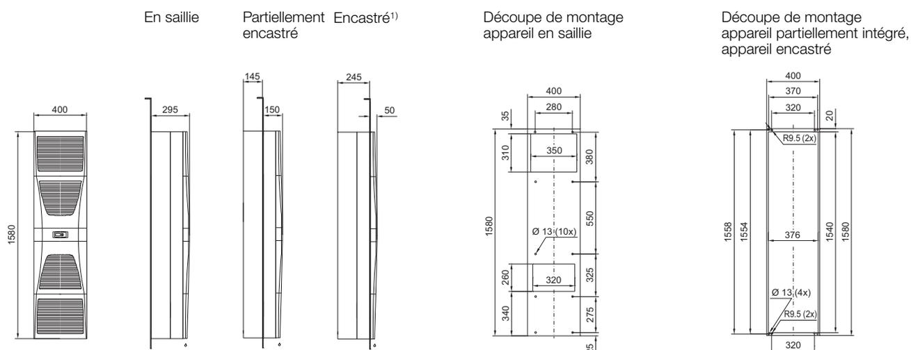
¹) Lorsque l'appareil doit être encastré dans une porte de 600 mm de largeur, il faut excentrer la découpe de montage d'au moins 10 mm en direction des charnières
