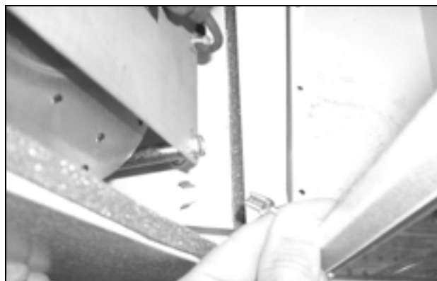
Afb. 55: Aardingskabel tussen afdekkap en chassis losnemen (2)
