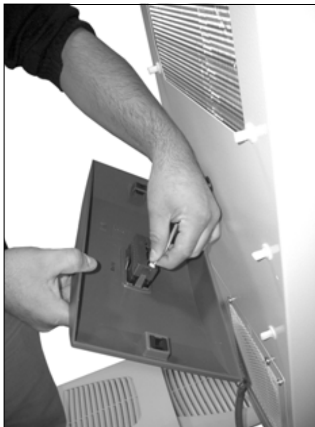
Afb. 43: Steker van het display losnemen (1)
