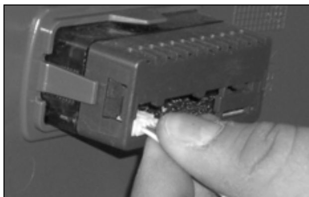
Afb. 44: Steker van het display losnemen (2)
