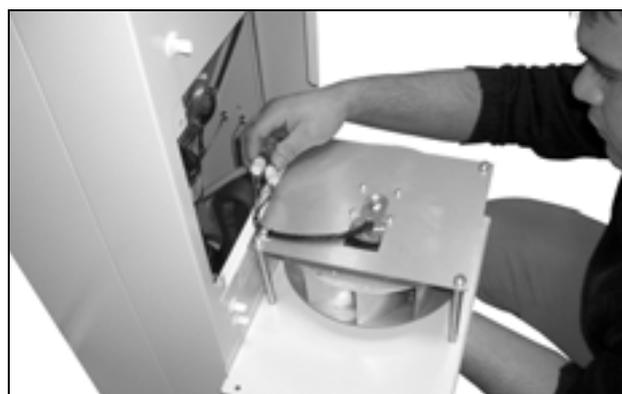
Fig. 70: Scollegare i connettori del ventilatore (1)
