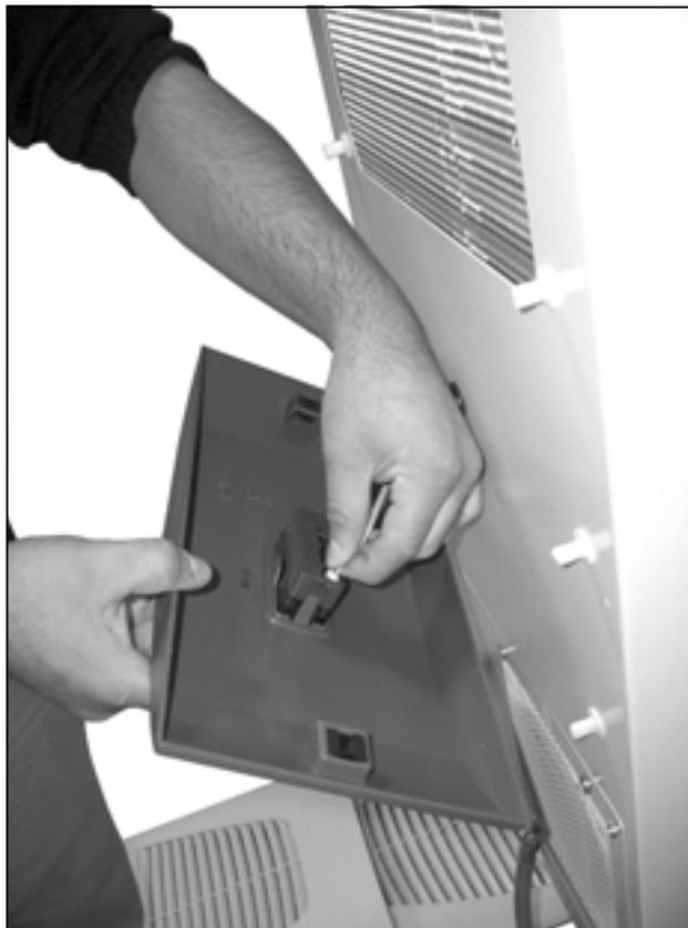
Fig. 43: Estrarre il connettore del display (1)
