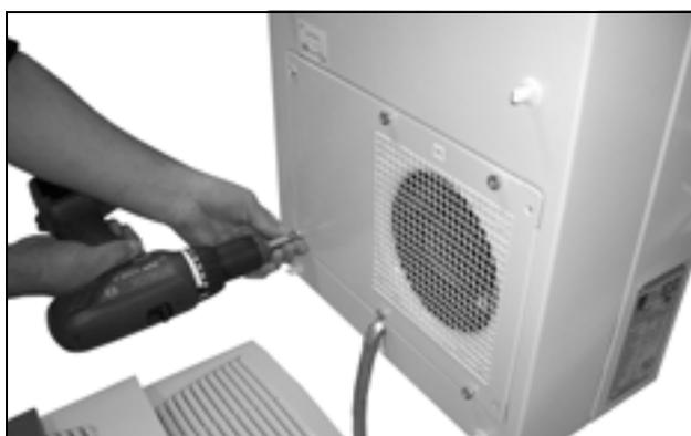
Fig. 46: Smontare il ventilatore del circuito esterno (allentare le quattro viti)
