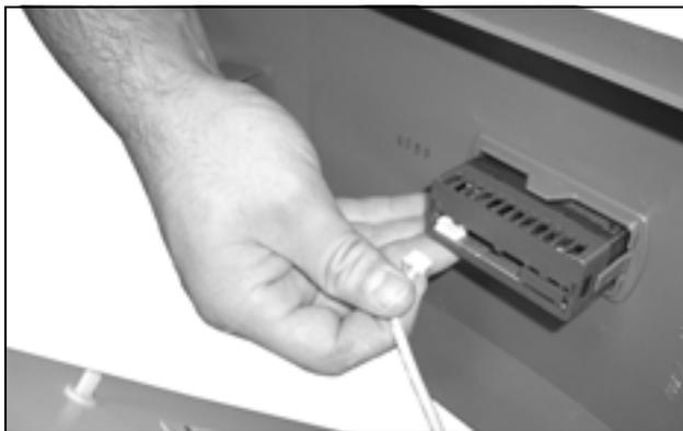
Fig. 65: Estrarre il cavo del display
