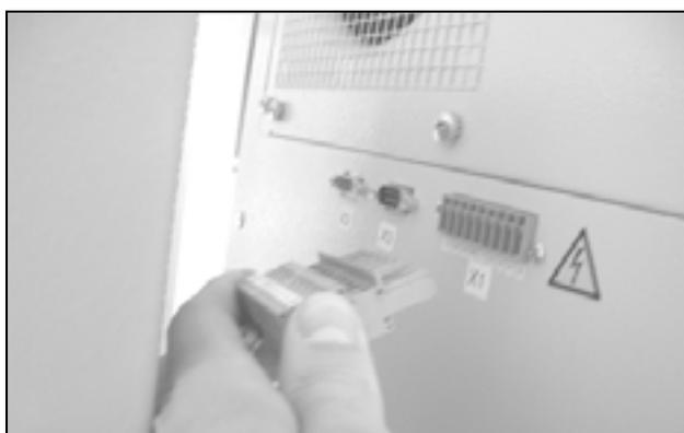
Fig. 58: Estrarre il connettore di alimentazione
