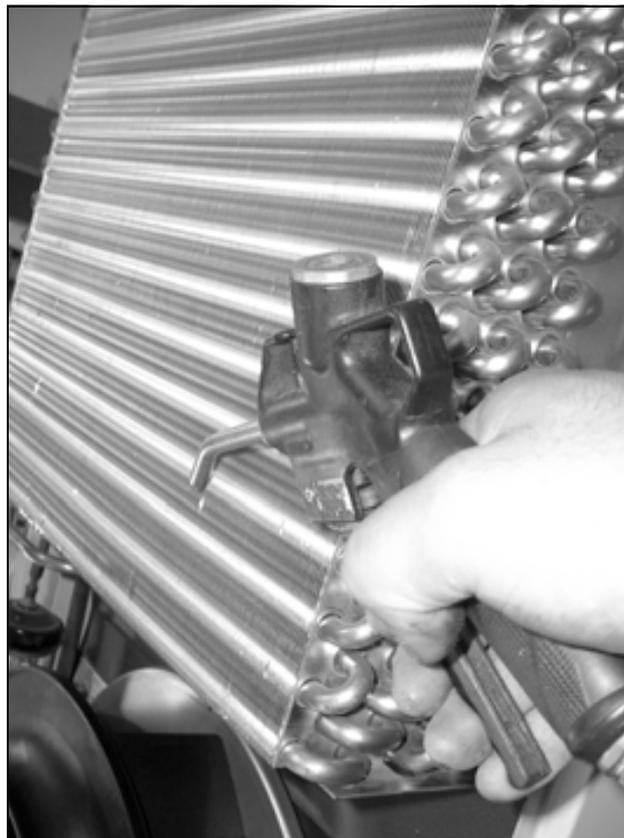
Fig. 80: Soffiare aria compressa sui tubi dello scambiatore di calore e nel vano compressore (2)
