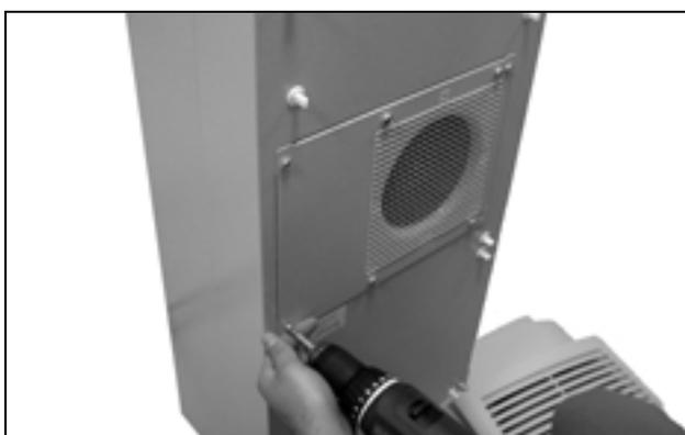
Fig. 68: Allentare le quattro viti del ventilatore del circuito esterno
