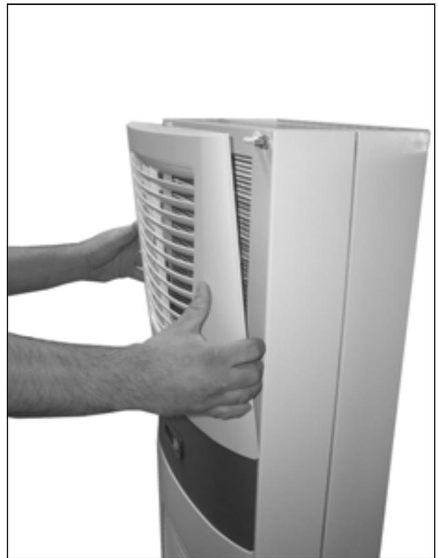
Fig. 40: Rimuovere la griglia di aerazione superiore
