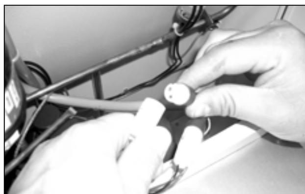
Fig. 72: Scollegare i connettori del ventilatore (3)
