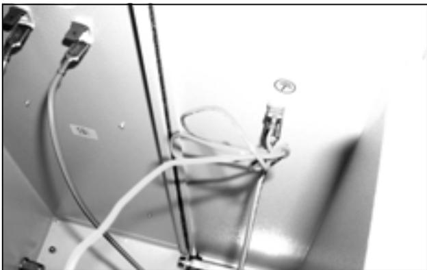
Fig. 73: Scollegare il cavo di massa del ventilatore (1)
