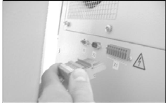
Fig. 39: Estrarre il connettore di alimentazione
