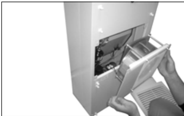
Imagen 69: Desmontar el ventilador del circuito exterior
