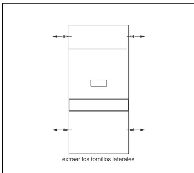
Imagen 84: Desmontaje cubierta (1)
