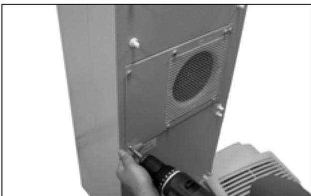
Imagen 68: Extraer los cuatro tornillos del ventilador del circuito exterior
