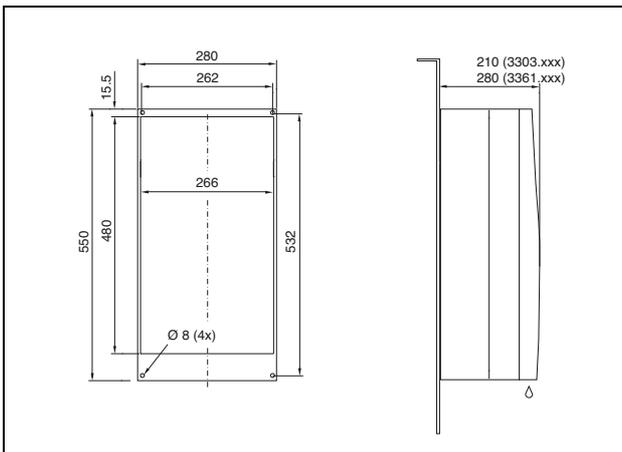
Imagen 126: 3303.xxx, 3361.xxx montaje exterior (excepto aparatos NEMA 4X)
