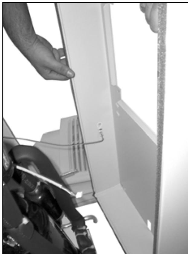
Imagen 77: Desconectar el cable de puesta a tierra (1)
