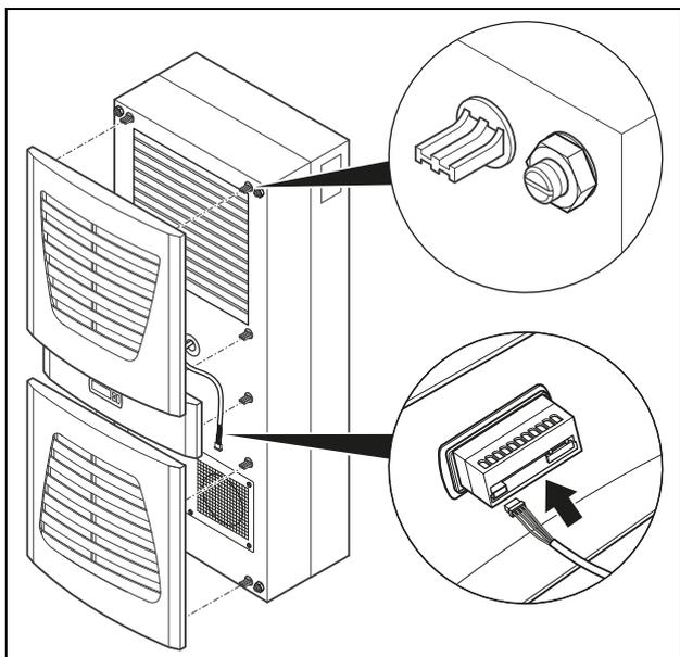
Imagen 32: Conectar el display y colocar la rejilla
