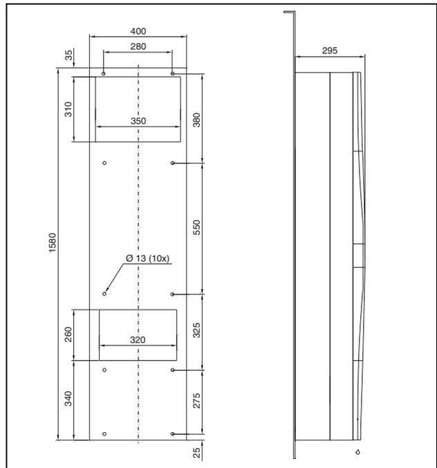
Imagen 129: 3328.xxx, 3329.xxx montaje exterior (excepto aparatos NEMA 4X)
