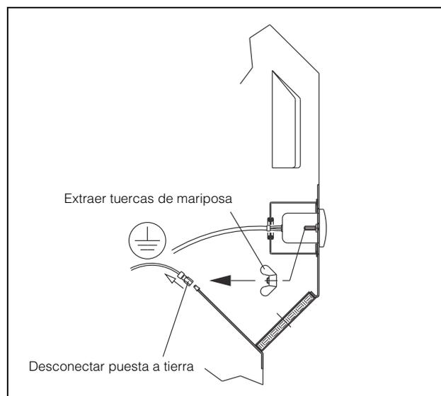
Imagen 85: Desmontaje cubierta (2)
