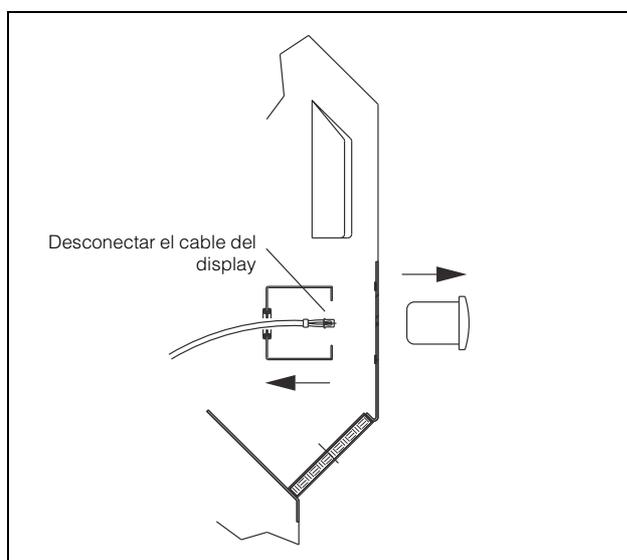
Imagen 86: Desmontaje cubierta (3)
