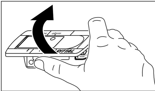
Imagen 34: Extraiga la pantalla del controlador básico
