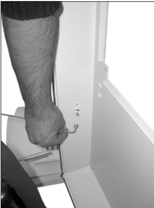
Imagen 78: Desconectar el cable de puesta a tierra (2)
