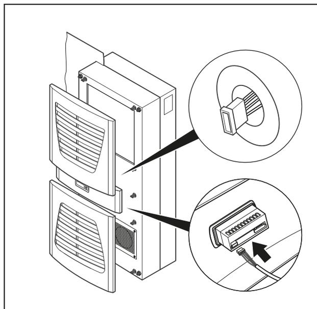
Imagen 14: Conectar el conector del display
