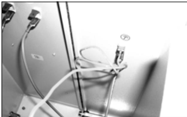
Imagen 73: Desconectar el cable de puesta a tierra del ventilador (1)
