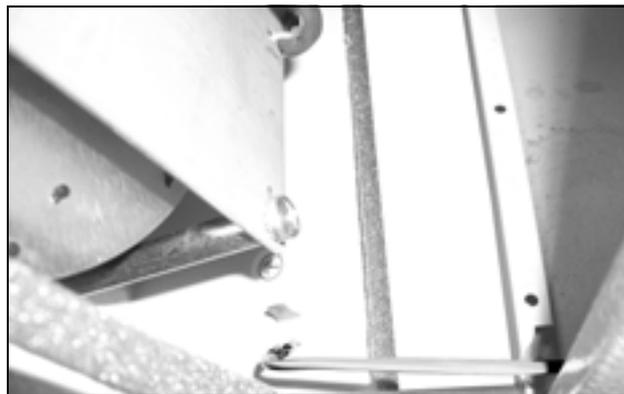
Imagen 54: Desconectar el cable de puesta a tierra entre la cubierta y el chasis (1)
