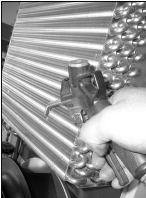
Imagen 80: Aplicar aire a presión en el registro del intercambiador de calor y el espacio del compresor (2)
