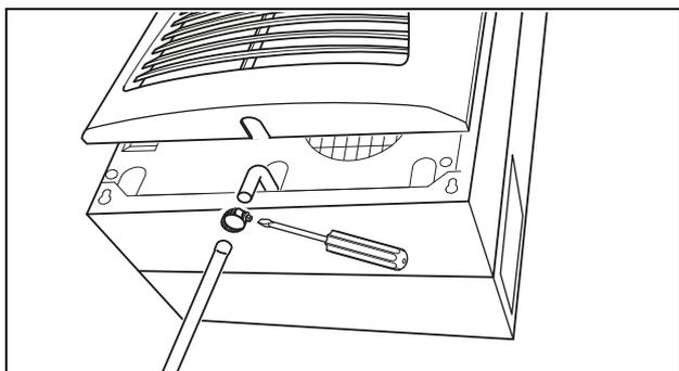
Imagen 19: Conectar la salida del agua de condensación
