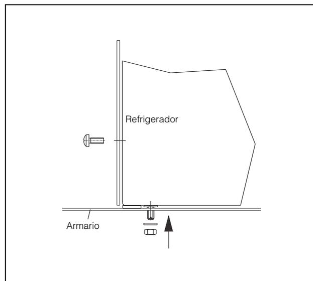
Imagen 83: Montaje del aparato
