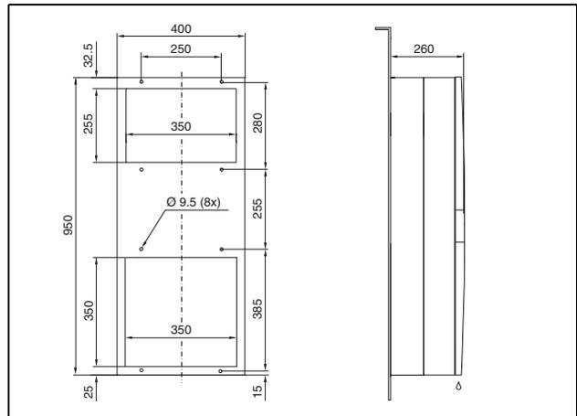
Imagen 128: 3304.xxx, 3305.xxx montaje exterior (excepto aparatos NEMA 4X)
