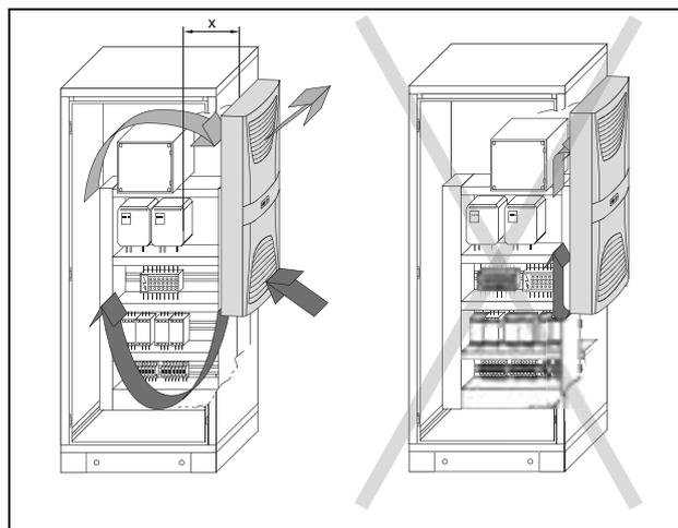
Imagen 5: Circulación del aire en el armario
