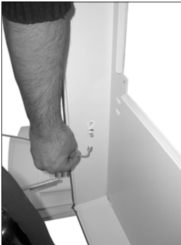
Fig. 78: Desencaixar o cabo de aterramento (2)
