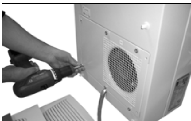
Fig. 46: Retirar o ventilador do circuito externo (soltar os quatro parafusos)
