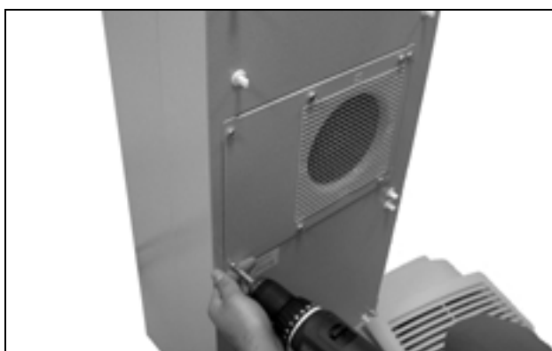
Fig. 68: Soltar os quatro parafusos do ventilador do circuito externo
