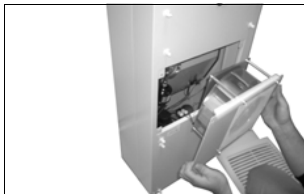
Fig. 69: Retirar o ventilador do circuito externo
