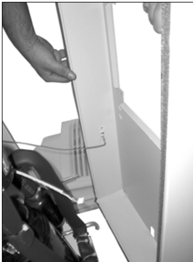
Fig. 77: Desencaixar o cabo de aterramento (1)
