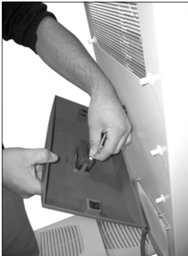
Fig. 43: Desencaixar o conector do display (1)
