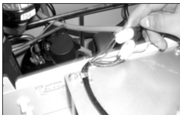
Fig. 71: Desencaixar os conectores do ventilador (2)
