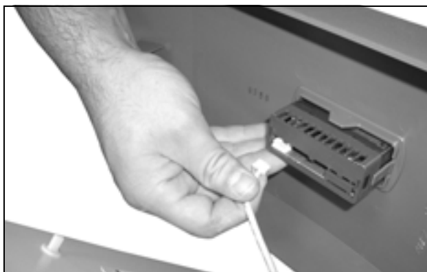
Fig. 65: Desconectar o cabo do display
