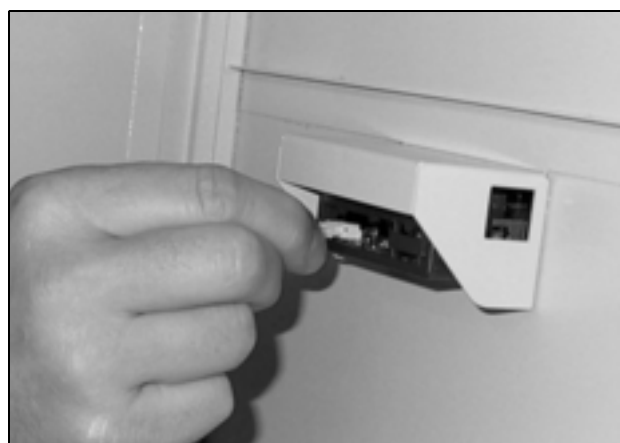
Fig. 29 : Ôter le connecteur de l'afficheur
