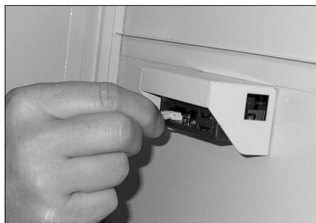
図 29: モニターのプラグを抜く
