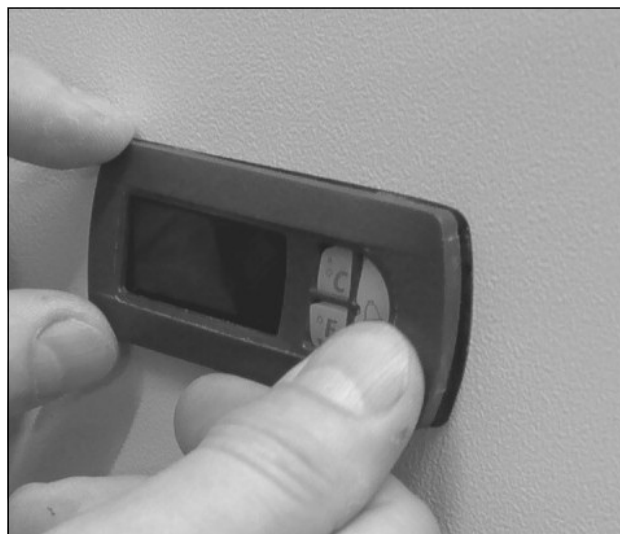
図 12: パネルの取付け
