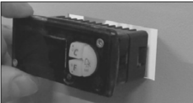
Fig. 10: Inserimento del display nell'apertura del carter porta
