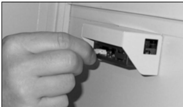
Fig. 15: Collegamento del cavo del display
