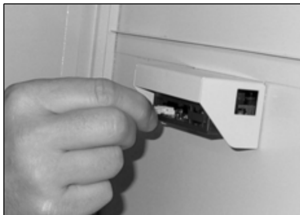
Fig. 29: Estrarre il connettore del display
