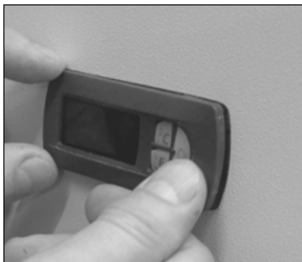
Imagen 12: Colocación de la tapa
