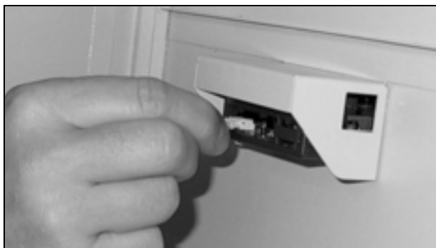
Imagen 15: Conexión del cable del display
