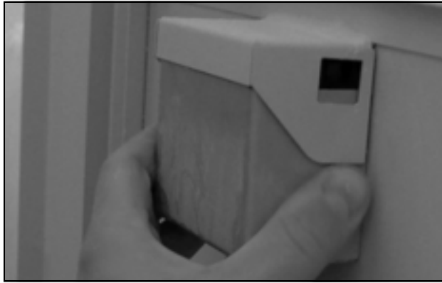
Imagen 14: Desmontaje de la tapa
