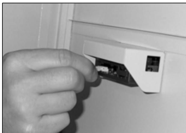
Imagen 29: Desconectar el display
