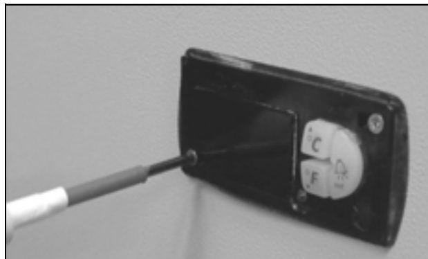
Imagen 11: Fijación del display
